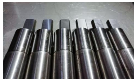
PPG48压缩机行业偏心轴工件
